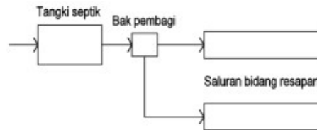
Gambar 7. Sistem resapan (Cipta Karya, 2002)
