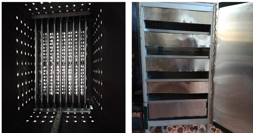
Gambar 1. Tungku berpenukar kalor dan ruang pengering
