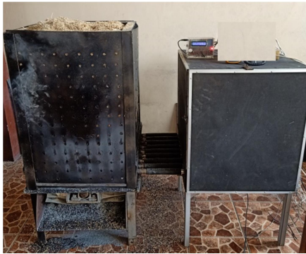
Gambar 2 Alat pengering berpenukar kalor dengan sumber energi biomassa sekam padi
