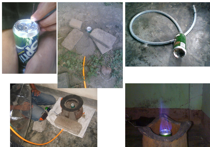
Gambar 2. Kompor sangat sederhana dengan menggunakan bahan kaleng bekas minuman dengan tungku tanah.
