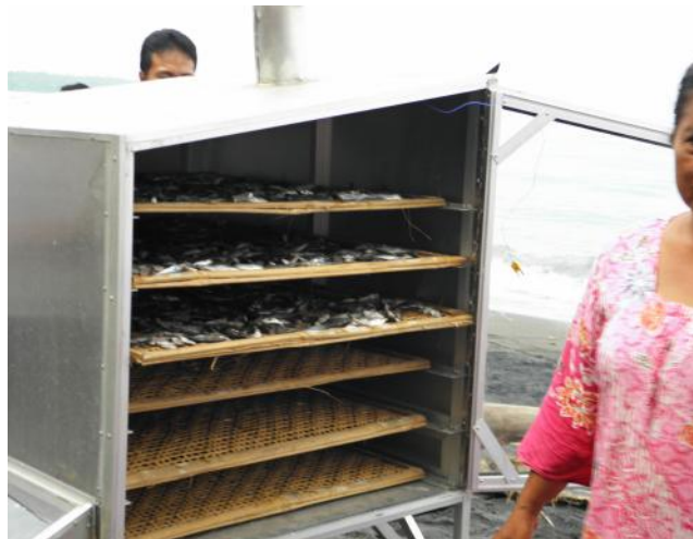
Gambar 4. Uji coba penering surya mengeringkan ikan teri
