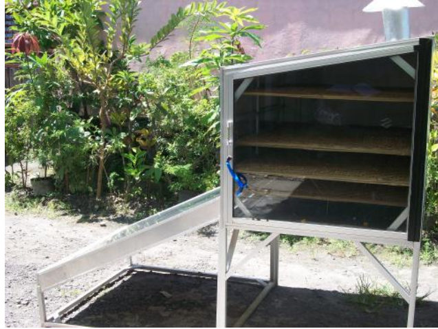
Gambar 3. Hasil rancangan penering surya untuk mengeringkan ikan teri
