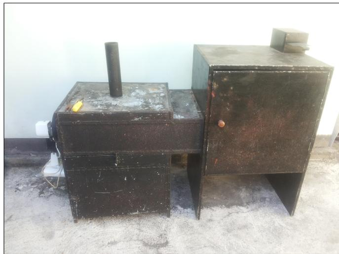
Gambar 2. Pengering biomassa untuk dodol buah
