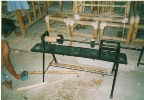
Gambar 3. Penyiapan Proses Pembelahan dan Pembesutan Bambu
