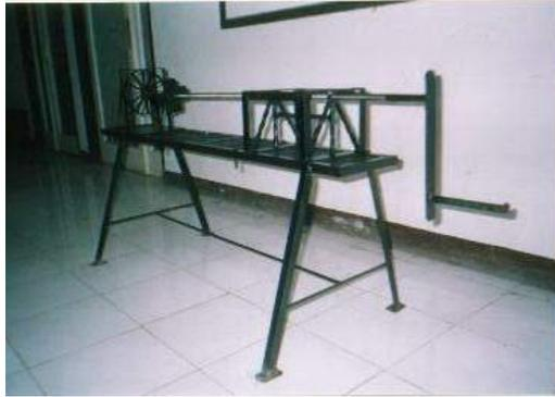
Gambar 2. Mesin Pembelah Dan Pembesut Bambu
