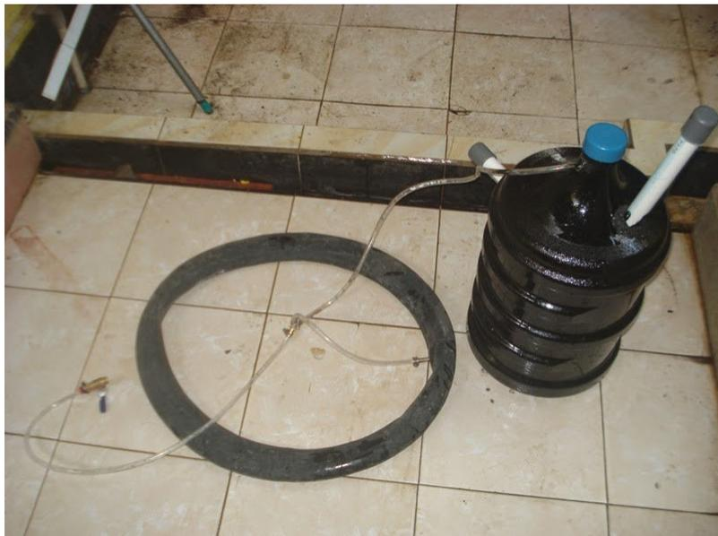
Gambar 5. Alat peraga unit pembuat biogas
