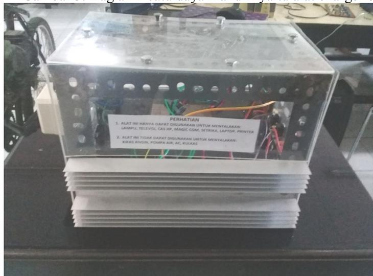
Gambar 4. Bagian 3 catu daya mandiri yaitu inverter
