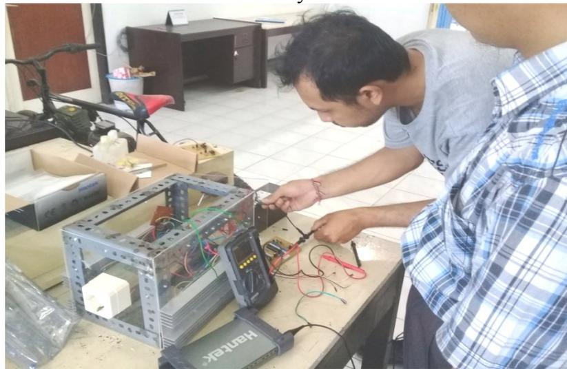
Gambar 1. Pembuatan dan pengujian catu daya mandiri bertenaga batere
