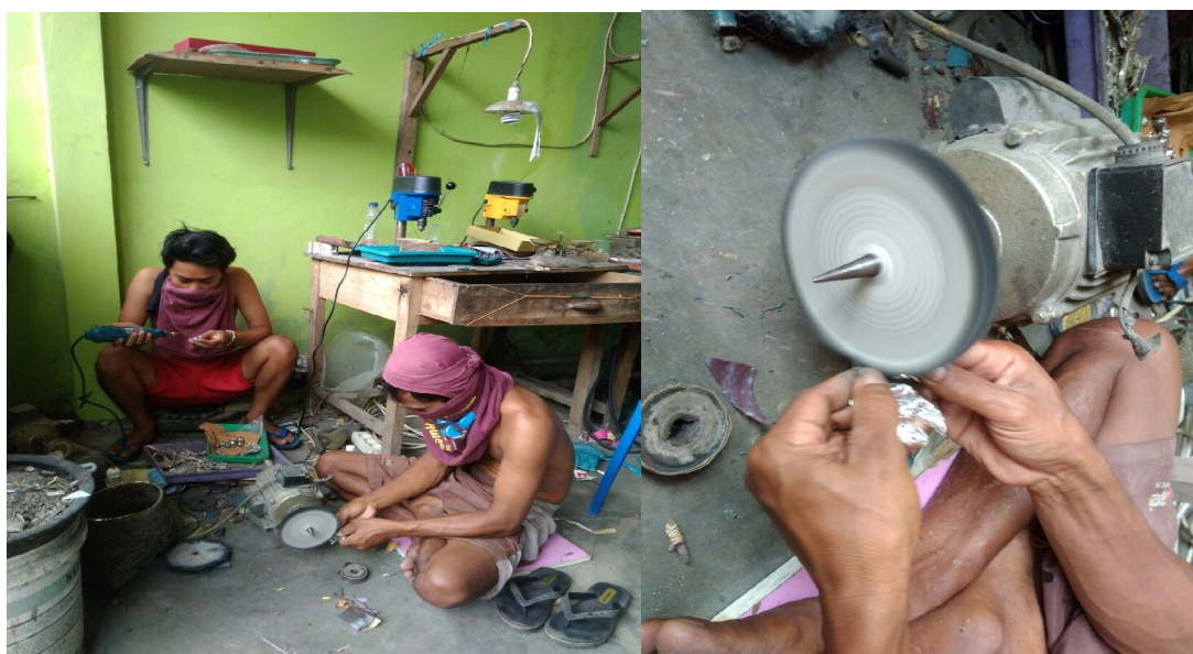
Gambar 1, Kondisi kerja saat poles produk perak yang kurang nyaman, duduk bersila dan sisa hasil polesan terbuang ( di lokasi Mitra sebelum pelaksanaan PPM )
