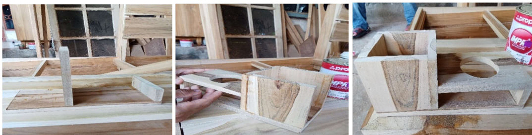
Gambar 2. Proses perakitan kayu membentuk desain tempat pensil
