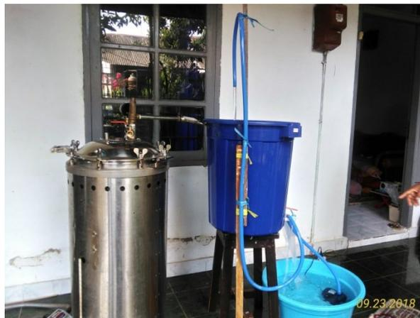
Gambar 2 Mesin destilasi minyak gaharu
