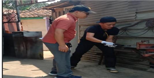
Gambar 15. Mengerol Bahan Untuk Komponen Yang Melengkung
