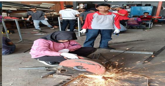
Gambar 9. Proses Pemotongan Bahan Menggunakan Mesin gerinda Duduk
