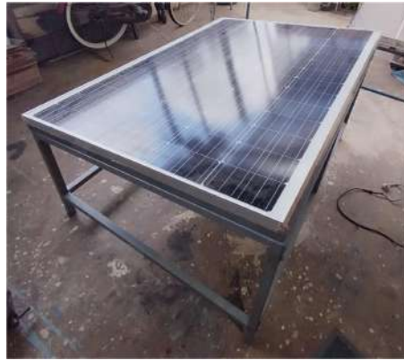
Gambar 2. Pembuatan alat peraga solarcell di atas rangka
