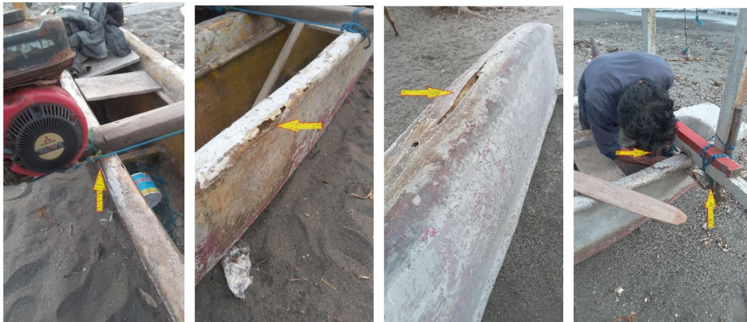
Gambar 1. Kerusakan sampan berbahan komposit sandwich terjadi pada:
