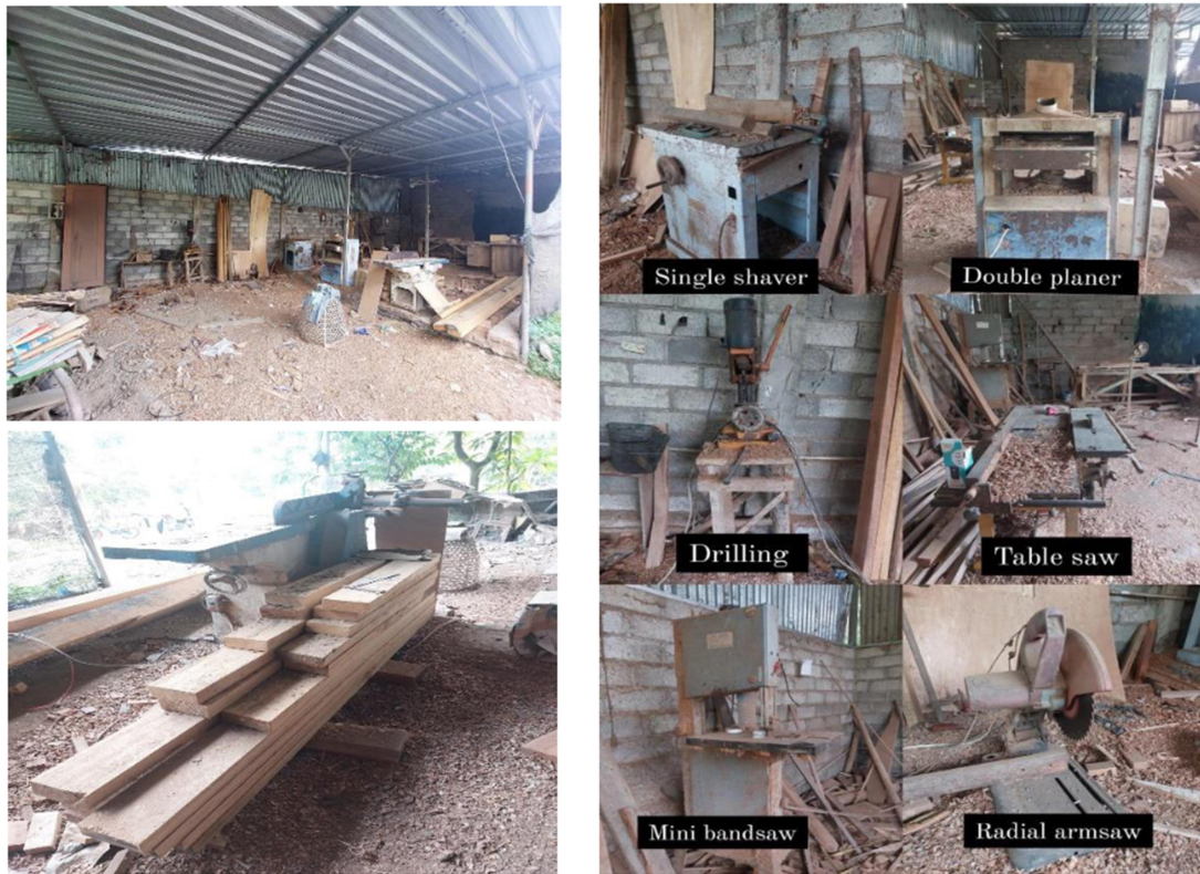
Gambar 1. Kondisi area produksi usaha pengolahan kayu (atas kiri), kondisi mesin-mesin pengolahan kayu (kanan), dan bahan baku untuk kusen (bawah kiri)
