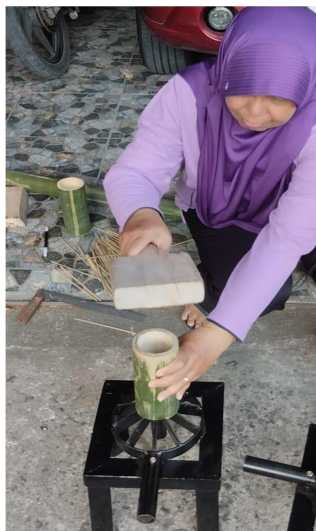
Gambar 7. Cara menggunakan alat pembelah bambu
