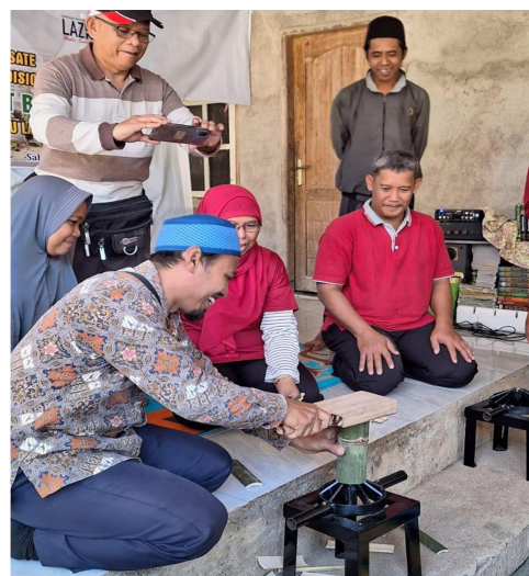
Gambar 8. Peserta penyuluhan dan salah seorang peserta yang mempraktekkan membelah bambu dengan alat pembelah bambu
