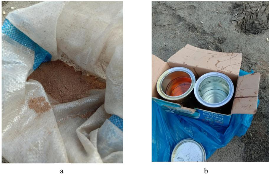
Gambar 2. Komponen Utama Perbaikan Perahu Nelayan. a. Serbuk Kayu b. Polyester dan Katalis
