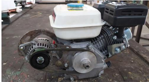
Gambar 4 Penambahan alternator pada mesin ketinting
