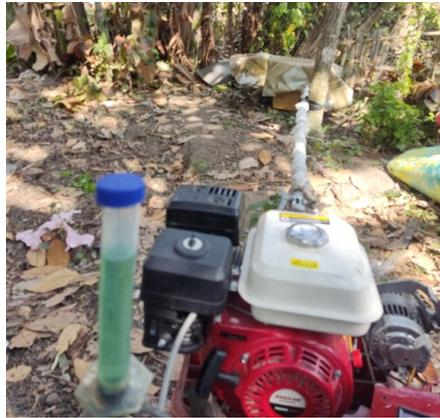
Gambar 6 Pengujian konsumsi bahan bakar
