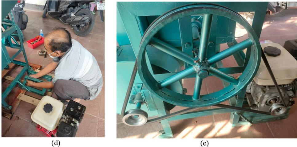
Gambar 3. Pengenalan dan cara perakitan mesin pengupas dengan pemasangan (a) *hopper*, (b) *blower*, (c) penggilas, (d) mesin penggerak, dan (d) system transmisi
