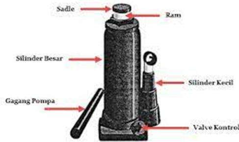
Gambar 9. Dongkrak Hidraulik
