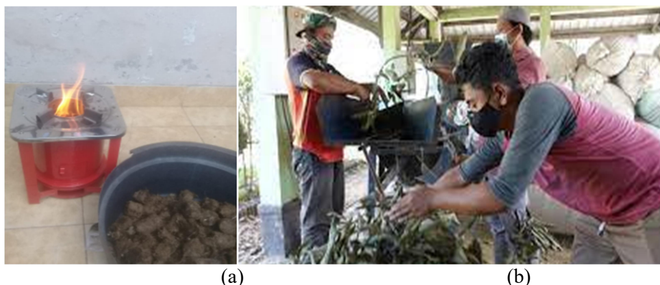
Gambar 9. Bentuk api bakaran briket di kompor biomassa dan upaya pembuatan briket di Tempat Pembuangan Akhir Sampah, Kebon Kongo, Lombok Barat untuk bahan bakar PLTU Jeranjang, Lombok Barat.
