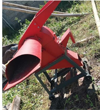
Gambar 1 Alat pencacah sampah biomassa yang digunakan dalam proses penghancuran sampah biomassa dalam kegiatan penyuluhan ini.
