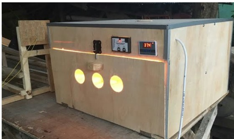
Gambar 3. Alat Penetas Telur Itik Dengan Kombinasi Kontrol Suhu Dan Kelembaban
