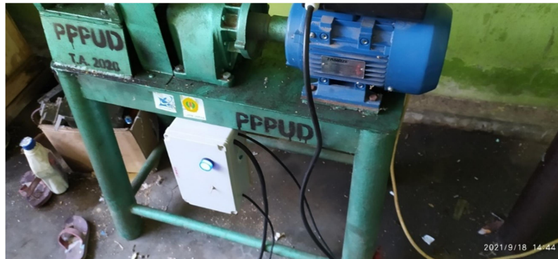
Gambar 3 Pemasangan kontrol arah putaran mesin penggiling perak pada UKM JEN'S Silver
